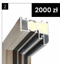
Ościeżnica aluminiowa ALU/90 trzykomorowa z podwójnym uszczelnieniem z przegradą PCW wypełniona pianą
