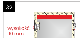
32 Wzmocnienie pod samozamykacz z blokadą ramienia DORMA z elementem mocującym ramie wymagane przy zakupie samozamykacza nawierzchniowego nie dotyczy wzorów Perfekt: 8, 8-1, 9, 9A, 9B Glass: 1A, 2B, 3B Glass View: 2B, 3B
